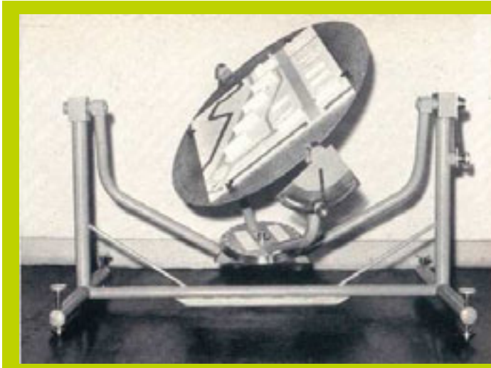
Het 'zonne-apparaat bij de afdeling Stadsontwikkeling', dat gebruikt werd om de zon/schaduwgevolgen bij verschillende verkavelingen en bijhoogtes te onderzoeken. (G.J. Bruyns, 1956, pp. 47-49)
